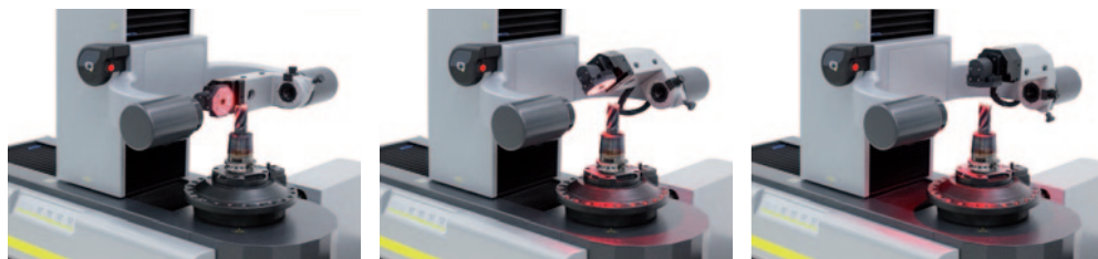
»venturion 450« s kontrolom alata ZOLLER. Kamera je okretna u području 0–180 °.
