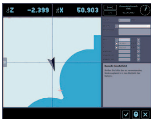
Navigacijski sustav »compass« za brzo i jednostavno pomicanje osi za pozicioniranje na željenu mjeru
