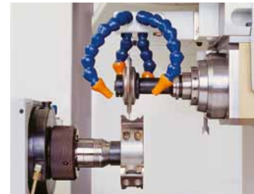
Direkt angetriebener Werkstückträger bis 1.000 1/min geeignet zum Rundschleifen
