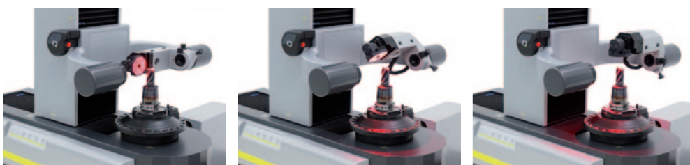
»venturion 450« s kontrolo orodja ZOLLER. Kamera je vrtljiva v območju 0–180 °.
