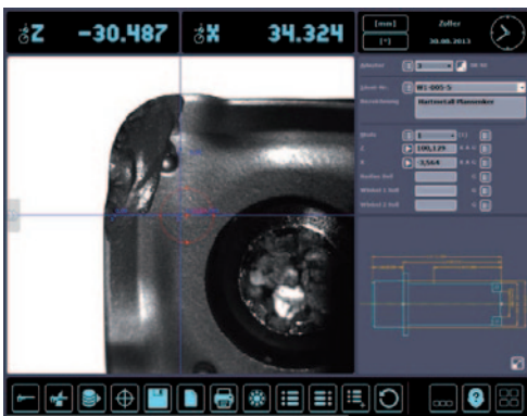
Funkcija projektorja in kontrola rezalnega roba za zaznavanje obrabe in loma
