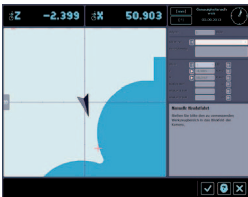
Navigacijski sistem compass za hitro in udobno premikanje osi za pozicioniranje na zeleno mero
