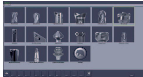
Posebni merilni programi s fotorealističnim vnosnim pogovornim oknom za kompleksne merilne naloge
